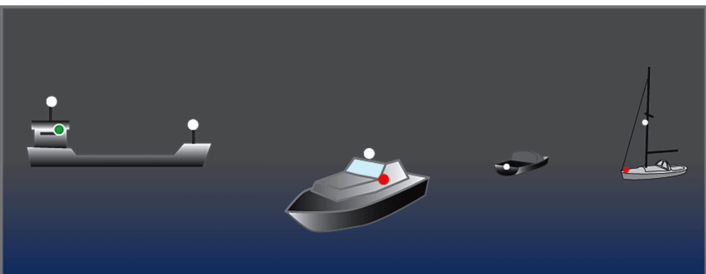
Från vänster sett över 50 m långt maskindrivet fartyg rör sig åt höger; under 50 m långt maskindrivet fartyg rör sig åt vänster; maskindrivet fartygs akterljus; fartyg, som är under segel och därjämte framdrivs med maskinkraft skall använda ljus för maskindrivet fartyg.
